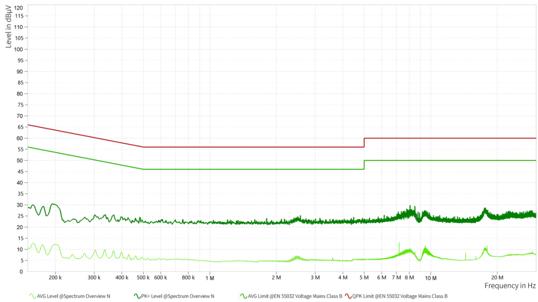
Rys. 8.7.2 Pomiar poziomu emisji przewodzonych w zakresie częstotliwości 150kHz ÷ 30MHz, linia N
