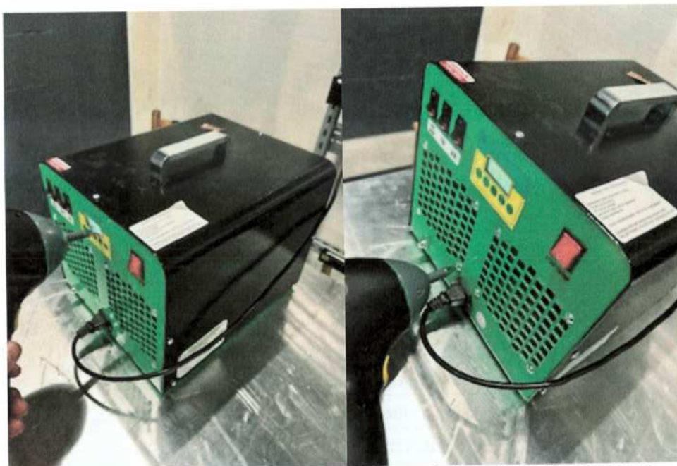
Fot. 8.1.1 Stanowisko do badań odporność na wyładowania elektrostatyczne
