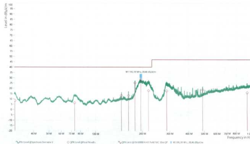
Rys. 8.8.1 Wyniki pomiaru poziomu emisji zaburzeń elektromagnetycznych promieniowanych w zakresie częstotliwości 30 MHz ÷ 1GHz, polaryzacja pozioma
