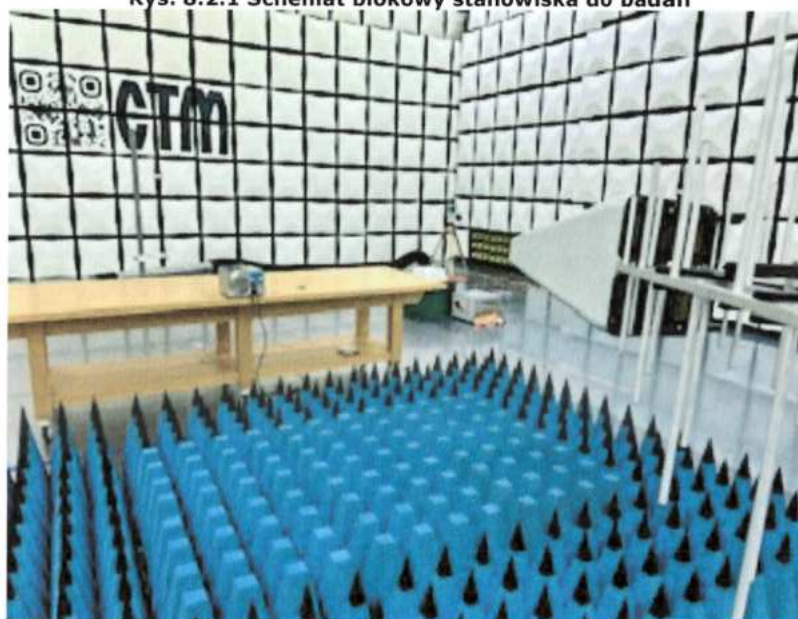
Fot. 8.2.1 Stanowisko do badań odporności na pole elektromagnetyczne (80MHz ÷ 6GHz)
